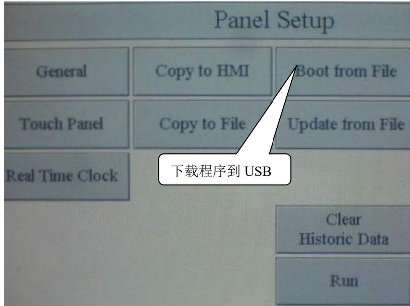
3. 选择下载的程序名称到触控屏 (Boot from File), 直到程序下载完为止。
