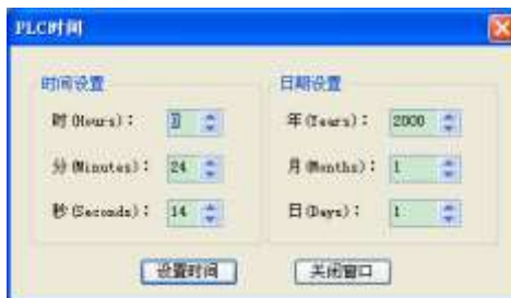
图2-22 设置 PLC 时间
