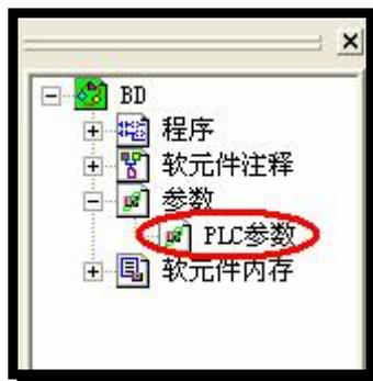
根据下图对 PLC 的通讯参数进行设置，其中“站号设置”是指当前 PLC 的站号，请根据实际情况进行设置。完成后下载到 PLC，需断电后重新上电，让设置生效。
