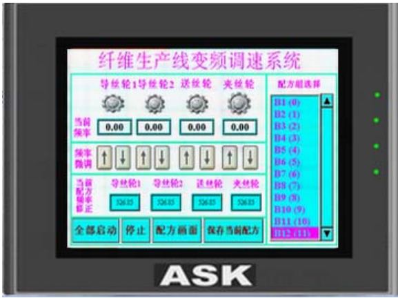
纤维生产线变频调速系统
