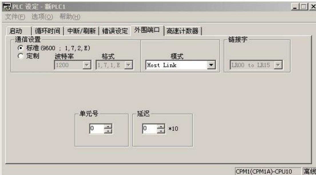
在 OMRON 软件里设置单元号、通讯速率、停止位、校验方式，其中单元号是指当前 PLC 站号，请根据实际情况进行设置。完成设置后下载到 PLC，需断电后重新上电，设置生效。
